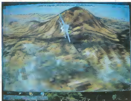
ERSTE MESSEDEMONS DES NV1-CHIPS VON NVIDIA ZEIGTEN REALISTISCHE, FLÜSSIGE FLUGSZENEN MIT 1024x768 PIXELN AUFLÖSUNG UND IN HI-COLOR AUF EINEM STANDARD-PC.
